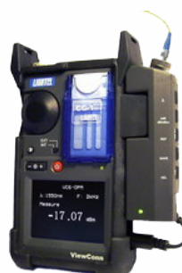
Puissance-mètre VC6-OPM, couplé au ViewConn®
